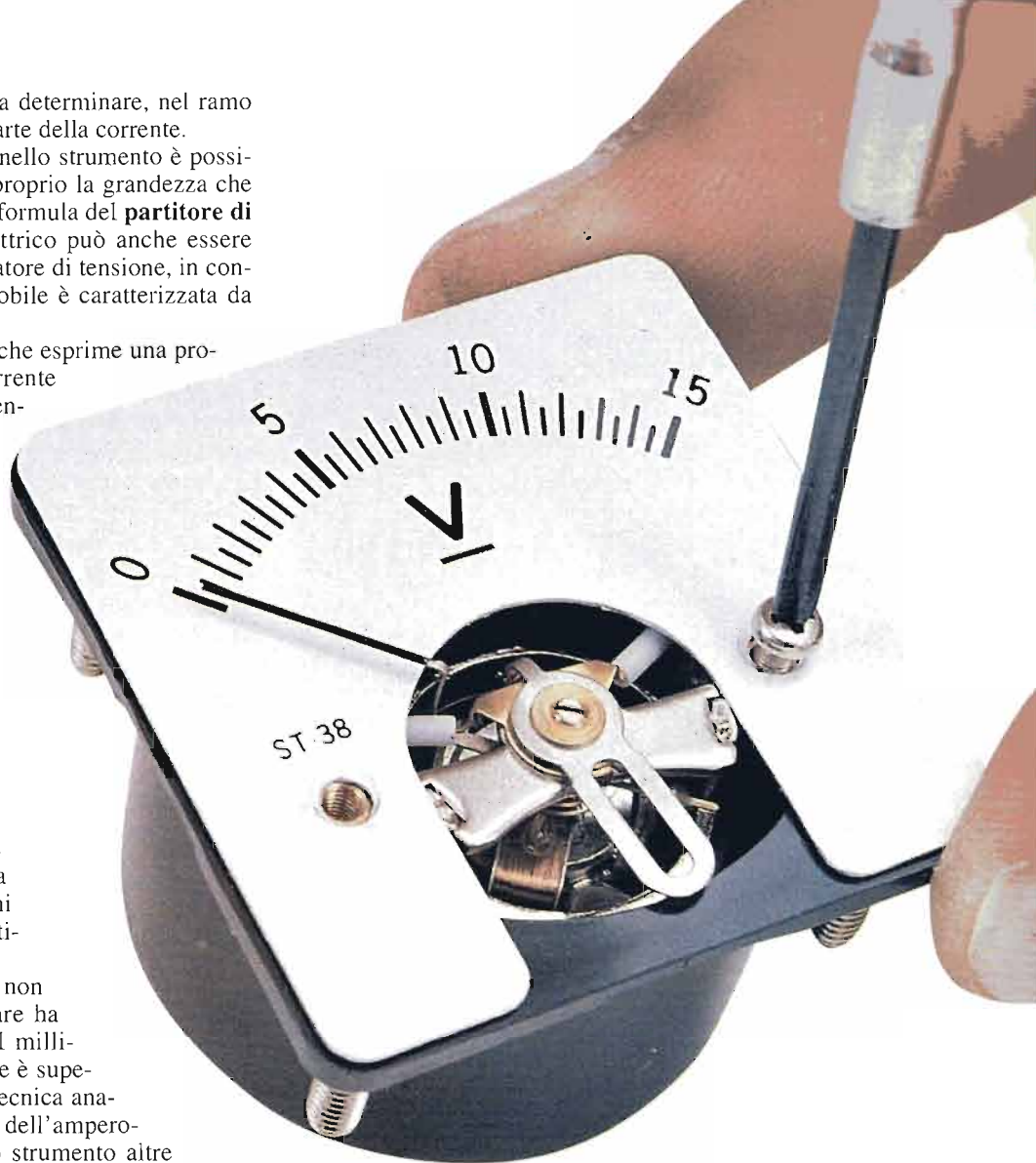
Il movimento dell'indice sulla scala graduata traduce la misura di una grandezza fisica, come una tensione, in una segnalazione di tipo visivo.
